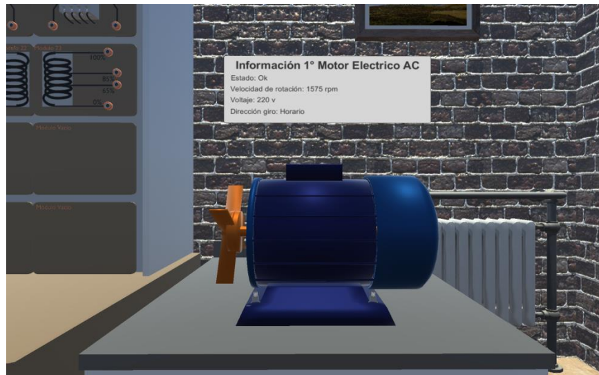
Figura 6. Ejemplo de monitorización de un motor eléctrico trifásico
